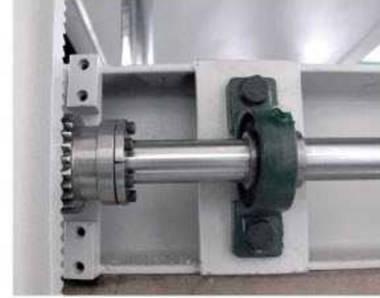
Dişli Kremayer Mekanizması İle İş Parçası Yüzeyine Homojen Baskı Gear Rack Mechanism On The Surface Of The Workpiece With Homogeneous Printing
